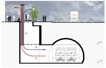
1 EL AIRE EXTERIOR ES ENFRIADO POR ENFRIAMIENTO EVAPORATIVO (AGUA Y VEGETACIÓN) 2 LAS TORRES DE VIENTO CAPTURAN EL AIRE FRESCO 3 EL AIRE ES CONDUCIDO AL INTERIOR MEDIANTE DUCTOS
