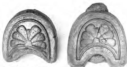
Matrices para estampado: vemos a la izquierda el positivo de plomo y a la derecha el negativo de zinc.
