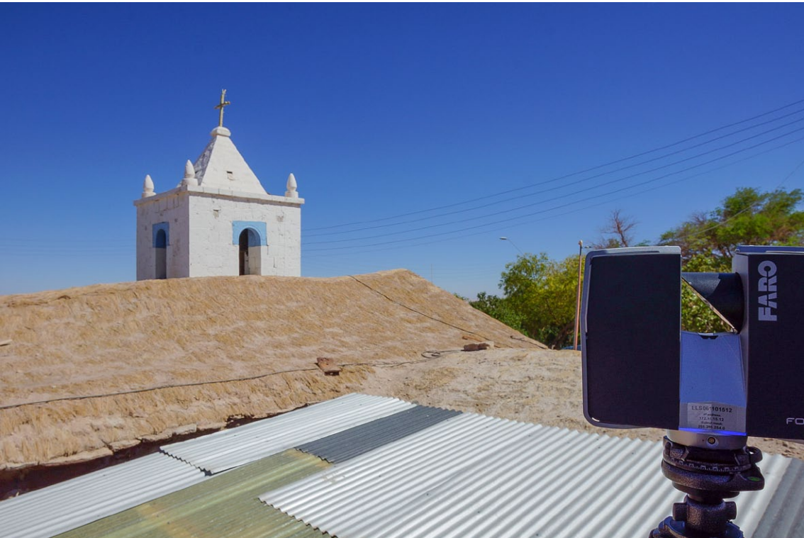
Figura 13 posicionamiento exterior del escáner en torno al volumen del edificio. Fuente: Laboratorio CILET 3D Escuela de Arquitectura 2014
