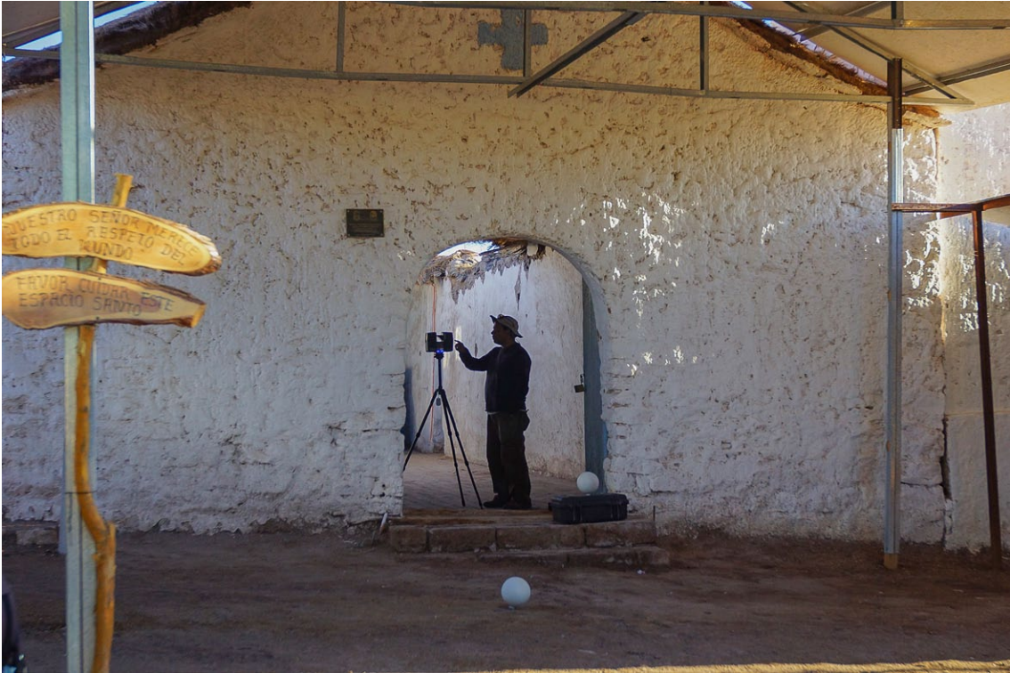
Figura 12 Colocación de esferas y ajuste de tomas en interior y exterior de la Iglesia. Fuente: Laboratorio CILET 3D Escuela de Arquitectura 2014
