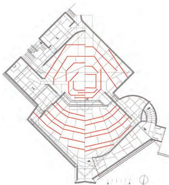
Figura 14 Planta sin mobiliario, subrayando las líneas del piso que muestran el orden radial de los recorridos y asambleas en torno al altar.
