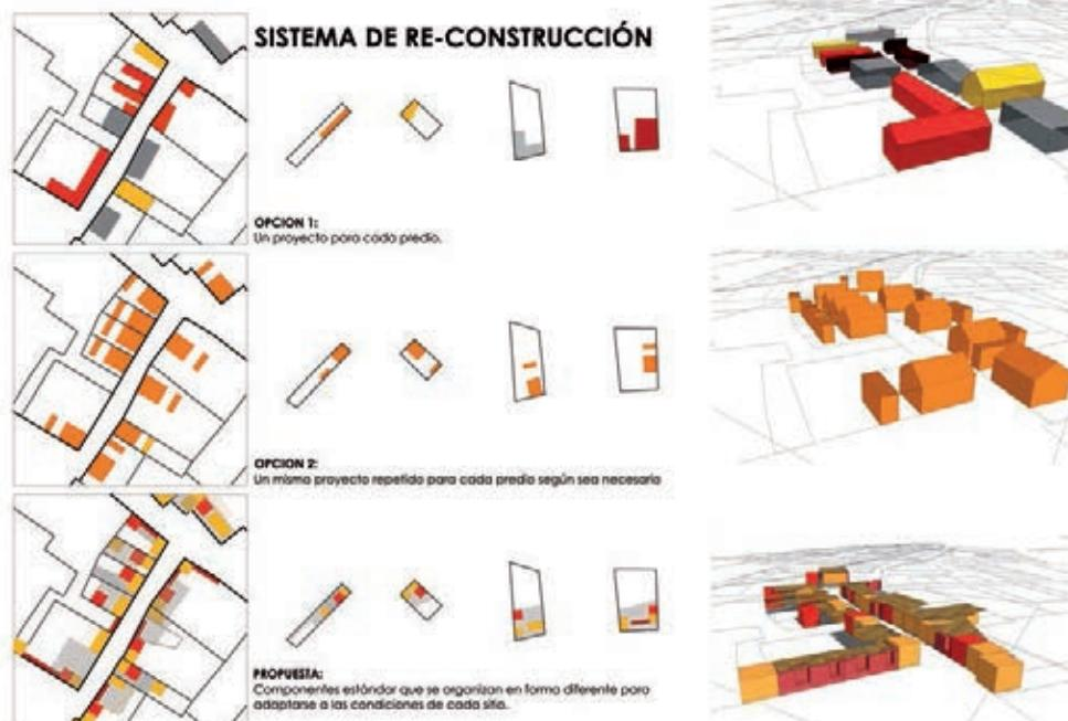
Figura 18 Esquema con posibilidades frente a la reconstrucción. La opción inferior corresponde a la propuesta: vivienda separada por componentes estándar que se organizan de forma diferente para adaptarse a las condiciones de cada sitio. Elaboración propia.
