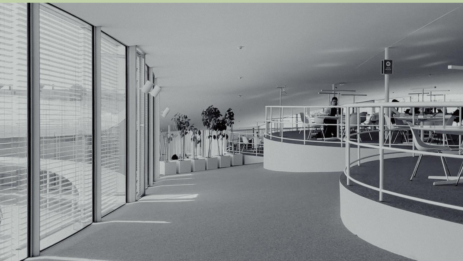
Figura 0. RLC. Floresiras impedem o acesso onde o desnível do piso se torna perigoso. Fonte: Arquivo de autores do 2023.
