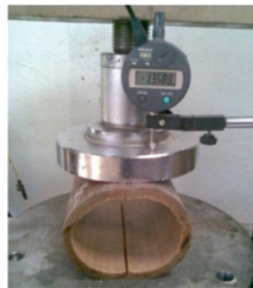
Figura 7. Esquema general ensayo compresión perpendicular
