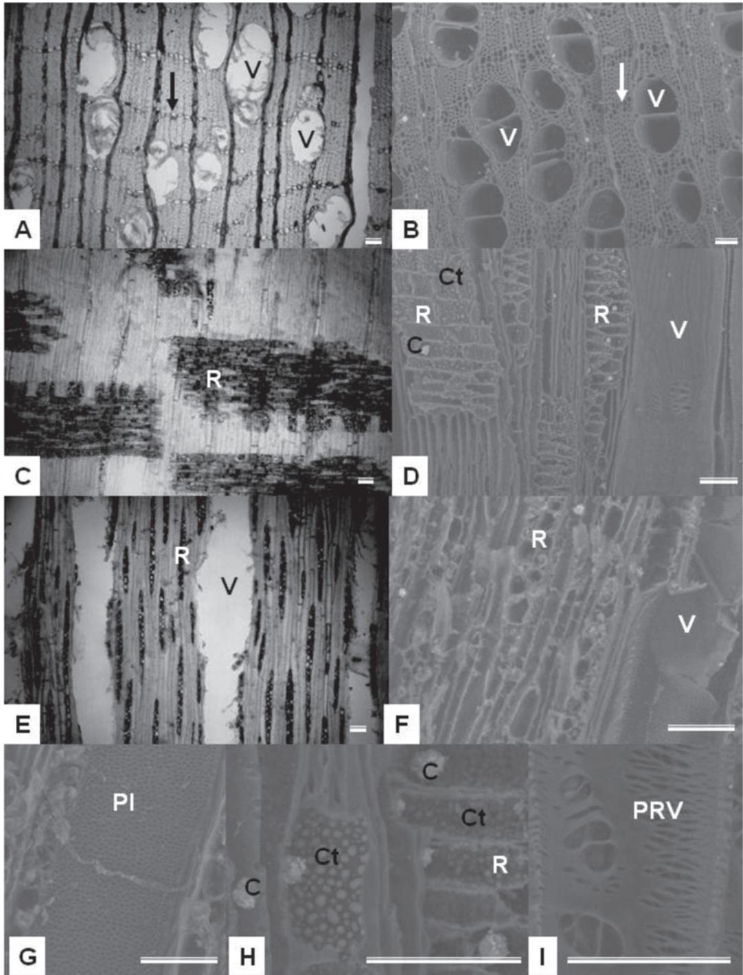
**Figura 4.** Aspecto microscópico de la madera (A,C,E) y MEB (B,D,F,G,H,I) del leño carbonizado de *Micropholis guianensis*. Flecha: parénquima axial; V: vaso; R: radios; C: cristal; Ct: contenido; PRV: puntuaciones radiovasculares; PI: puntuaciones intervasculares. Escala: 50  $\mu$ m.
