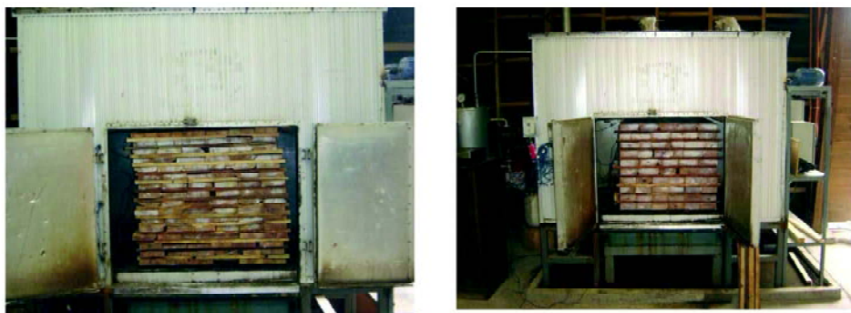
Figura 2: Distribución de la madera en el horno para espesores de 25 y 50 mm
