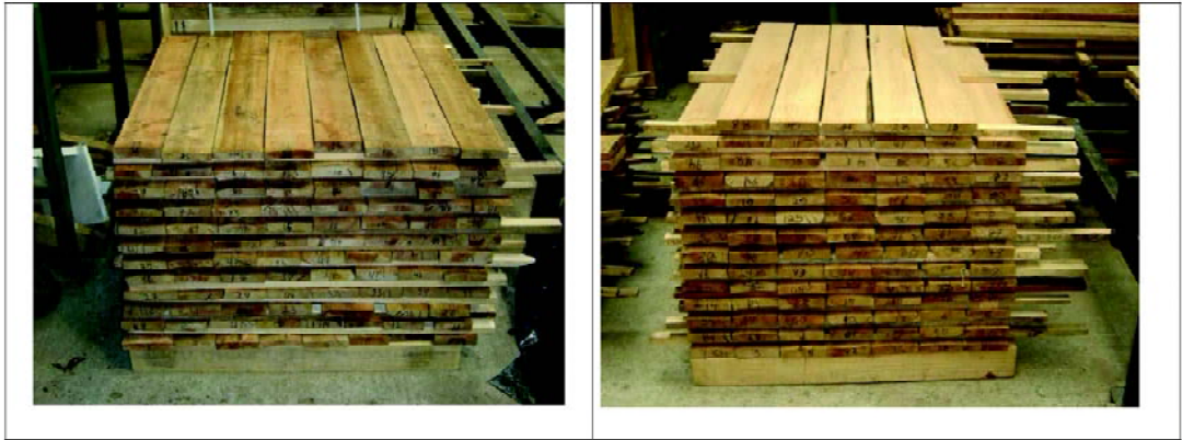
Figura 7: Madera seca antes y después del cepillado (renovales canelo 25mm de espesor).
