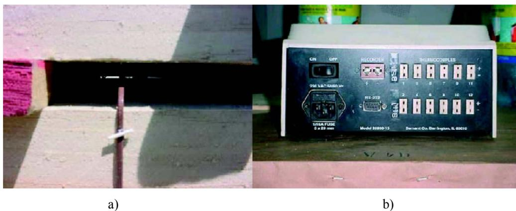
**Figura 2:** Instalación de termocuplas entre las camadas de madera y sistema de adquisición de datos de la temperatura.
