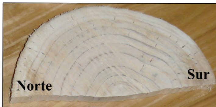
Figura 3. Orientación Norte-Sur en rodela de Eucalyptus nitens usada para medición de grietas.
