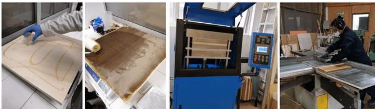
Figura 3: Proceso de fabricación de muestras de tableros contrachapados y maderas microlaminadas reforzados con fibras de ingeniería.
