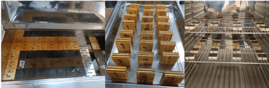
Figura 5: Determinación de propiedades físicas de tableros contrachapados y maderas microlaminadas.
