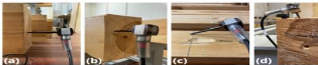
Figura 4: Mediciones longitudinales directas (a) y (b) e indirectas (c) y (d) con el Fakopp MST.
