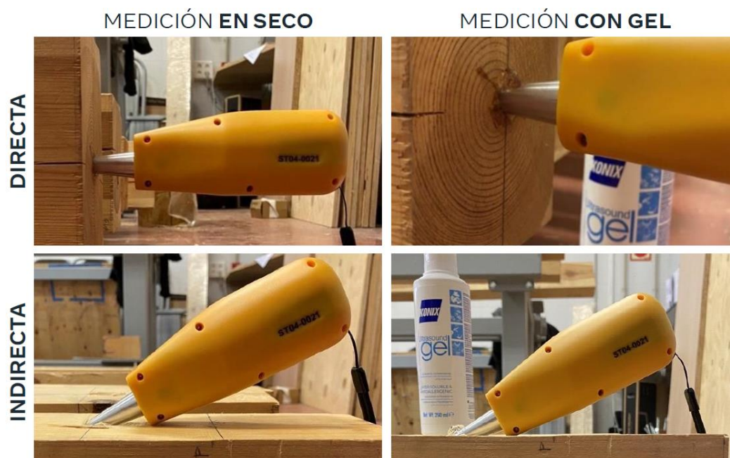
Figura 3: Imágenes de los 4 tipos de mediciones con el equipo Sylvatest 4.0.
