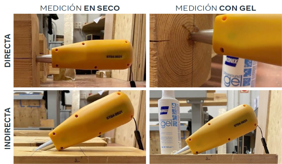
Figura 3: Imágenes de los 4 tipos de mediciones con el equipo Sylvatest 4.0.
