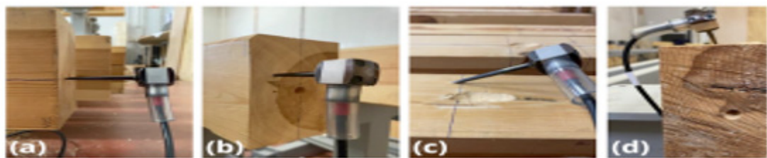
Figura 4: Mediciones longitudinales directas (a) y (b) e indirectas (c) y (d) con el Fakopp MST.
