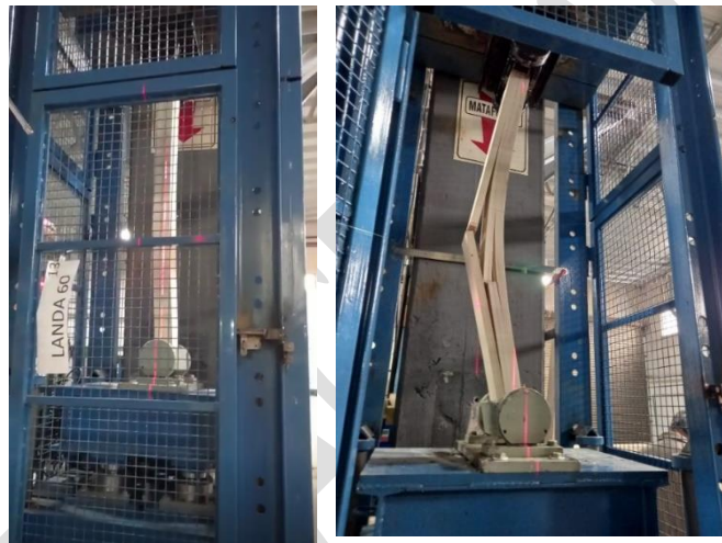
Figura 1: Ensayo a compresión axial centrada.
