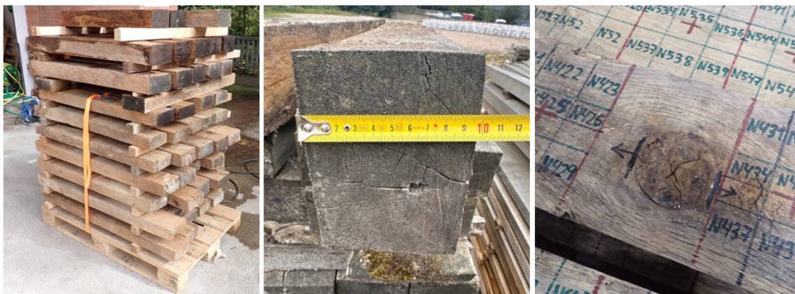
Figura 1: Lote de madera de roble empleado, selección de elementos y preparación de probetas.
