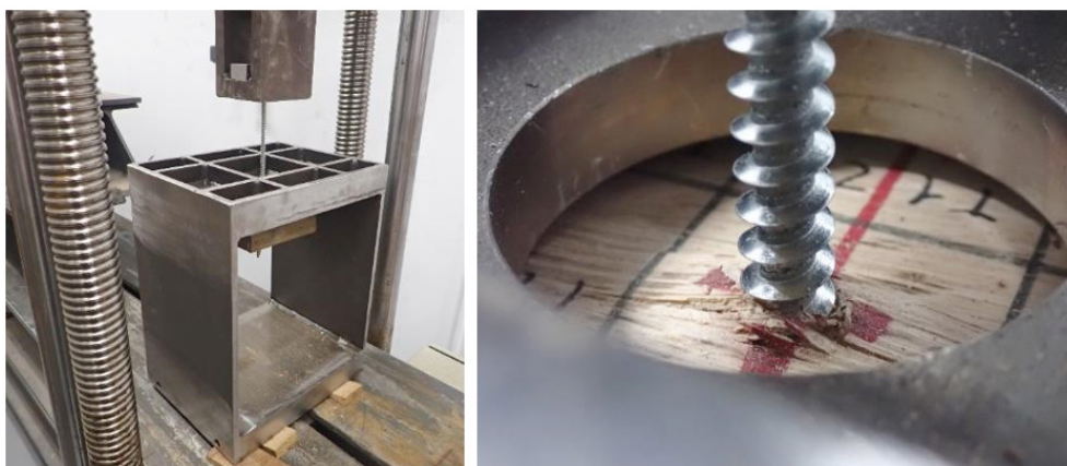
Figura 2: Dispositivo de aplicación de carga (izquierda) y probeta tras el fallo por arranque (derecha).
