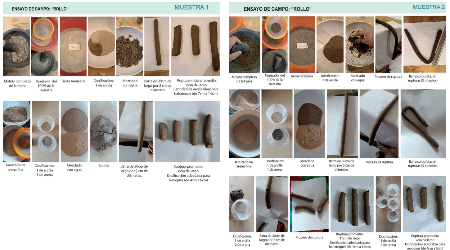
Figura 5. Ensayo de campo tipo rollo (a) Muestra 1; (b) Muestra 2. Fuente: Elaboración de los Autores basada en Pahaut et al. (2020).
