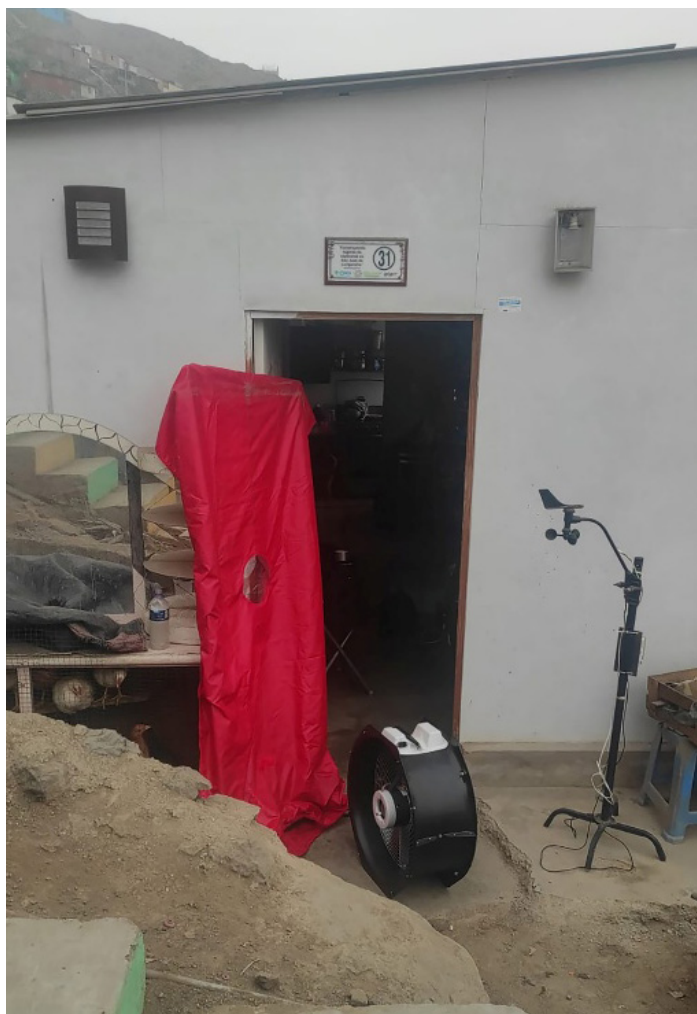
Figura 5. Izquierda. Puerta sopladora instalada en la Vivienda V03. Fuente: Elaboración de los Autores. Figura 6. Derecha. Sensores instalados en la Vivienda V02. Fuente: Elaboración de los Autores.
