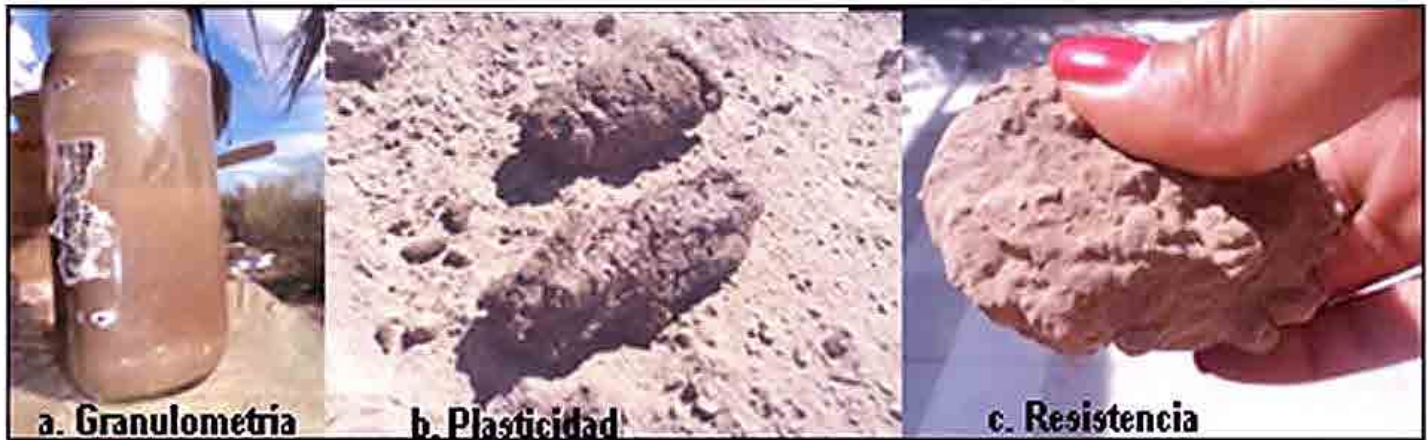
Figura 3. Pruebas de selección de la tierra. Fuente: Elaboración propia. Febrero 2013
