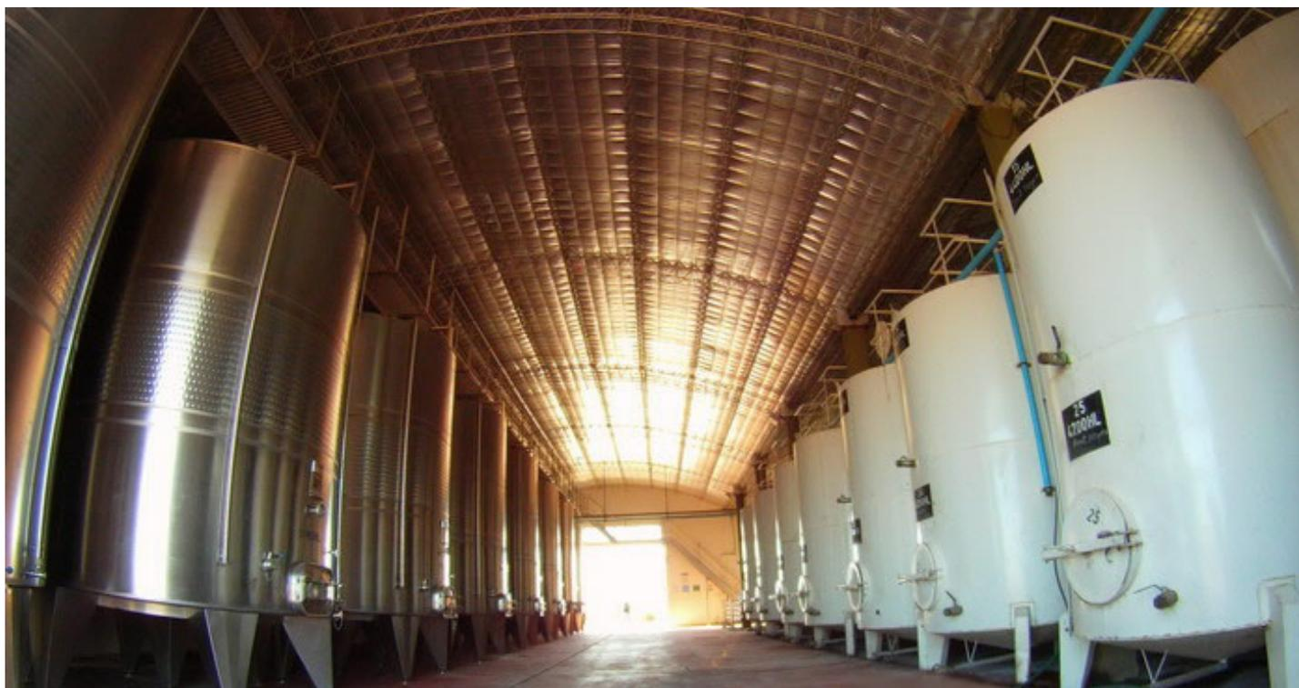
Figura 2. Interior de la bodega modelada y vista de la batería de tanques de acero inoxidable modelados para este trabajo (izq.) y de acero negro recubierto con epoxi (der.). Fuente: Empresa VC SA (2018).
