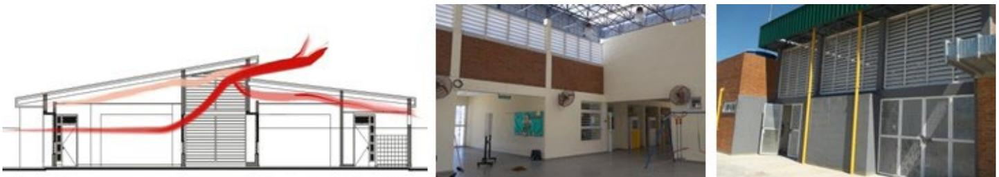
Figura 4. Esquema de ventilación natural. Fotos interior y exterior del SUM. JI 174. Fuente: Elaboración de los autores.
