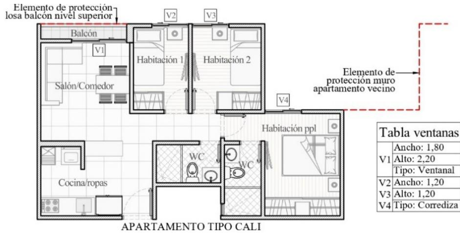
Figura 3. Plantas arquitectónicas de vivienda tipo para Cali, indicando ubicación de aberturas y de obstrucciones. Fuente: Elaboración de los autores.
