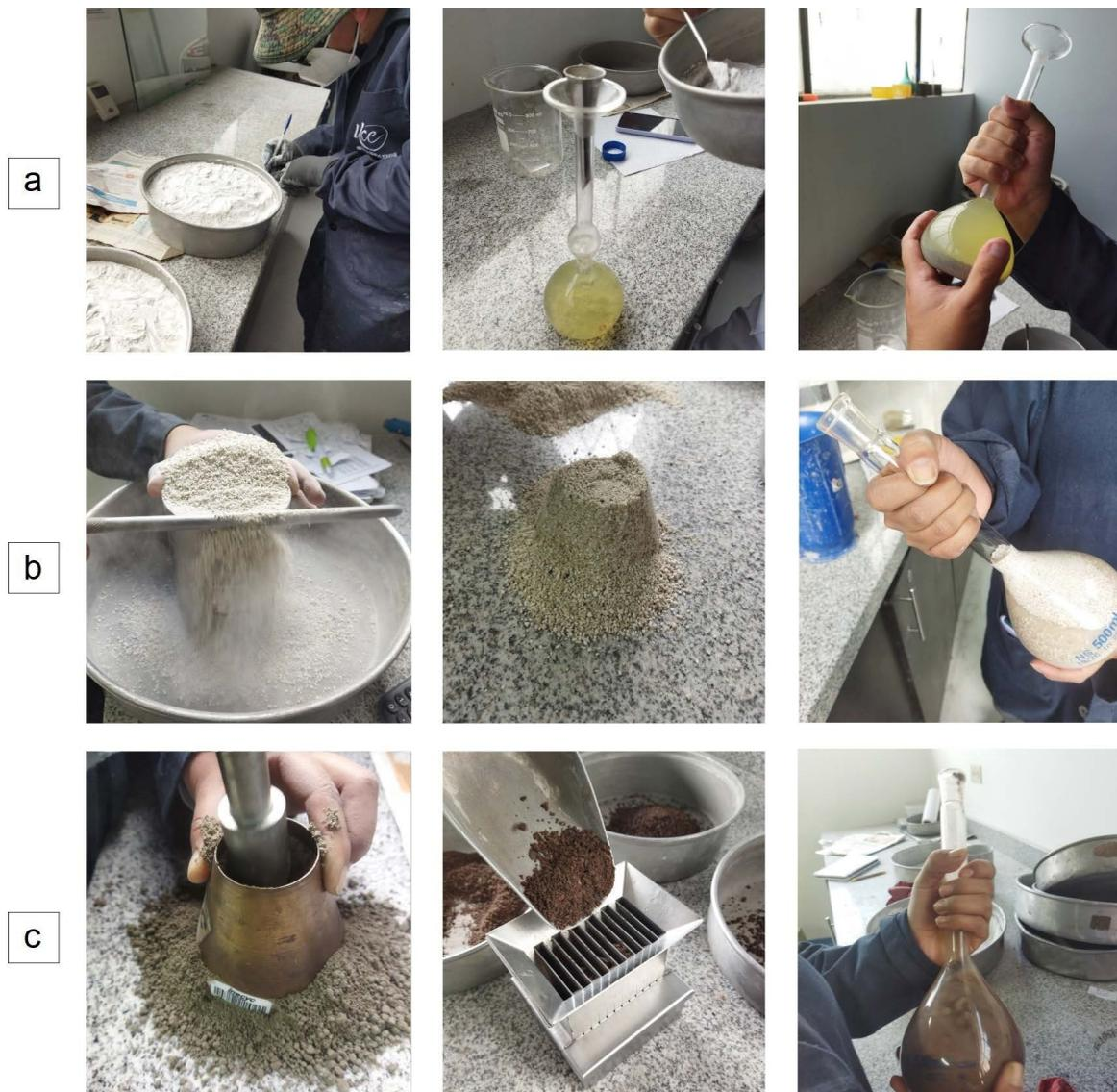
Figura 5: Ensayos de laboratorio: a) cemento y cal, b) perlita, c) arena. Fuente: Elaboración de los autores.
