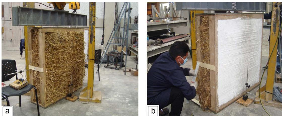
Figura 12. Ensayo a compresión de paneles: a) sin mortero, b) con mortero. Fuente: Elaboración de los autores.
