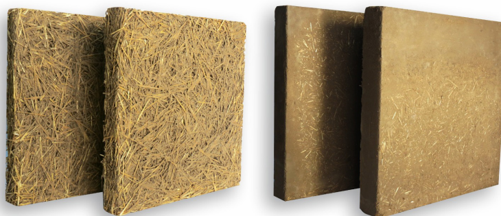
Figura 1: Probeta para ensayo térmico: a) Relleno liviano, b) Revoque de tierra. Fuente: Elaboración de los autores
