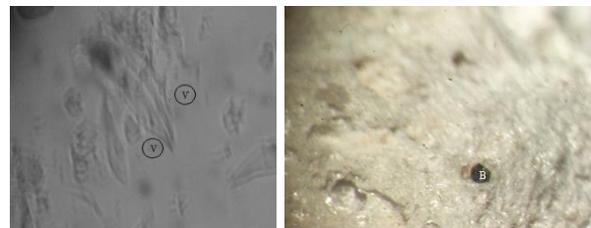
**Figura 4:** Microfotografías de un campo donde se observa a izquierda la presencia de vidrio (V) y a derecha superficie de un trozo de piedra pómez, con inclusión de mica (B). Fuente: Elaboración Propia.
