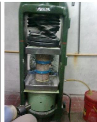
**Figura 7:** Resultados del ensayo y equipo de compresión a los 28 días. Fuente: Elaboración Propia.
