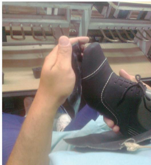
**Figura 7.** Exemplo de colagem de solado no calçado.
