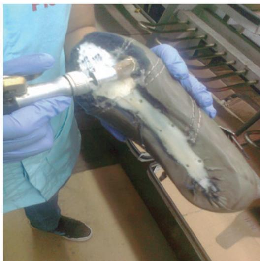
**Figura 4.** Exemplo de aplicação de adesivo no calçado.
