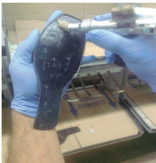
**Figura 5.** Exemplo de aplicação de adesivo no solado.
