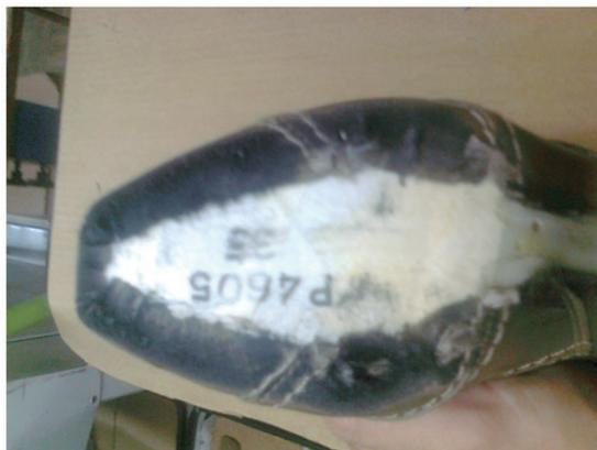
**Figura 2.** Exemplo de calçado asperado (lixado).
