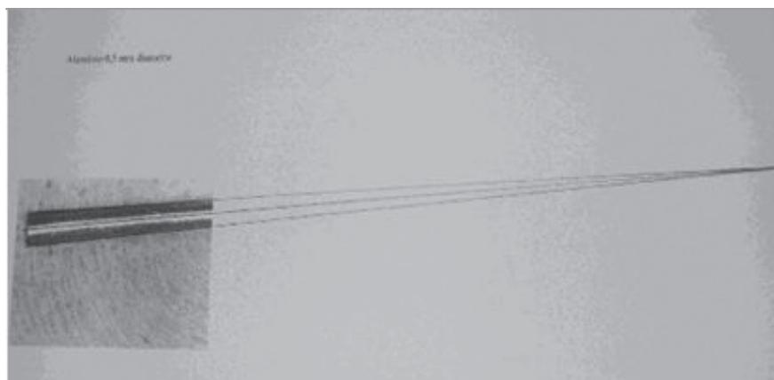
**Figura 7.** Obtención de la conicidad (probeta de aleación de aluminio)
