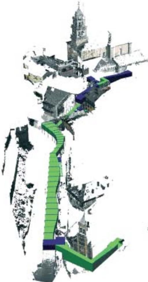
*El modelo generado por el escáner láser tridimensional junto con el modelo sólido del puente propuesto.*
