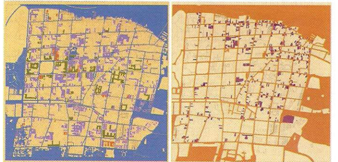
Usos Altura de Edificación, verde 3 pisos, violeta 2 pisos, Edificios muy deteriorados, color burdeos; amarillo, 1 piso.
