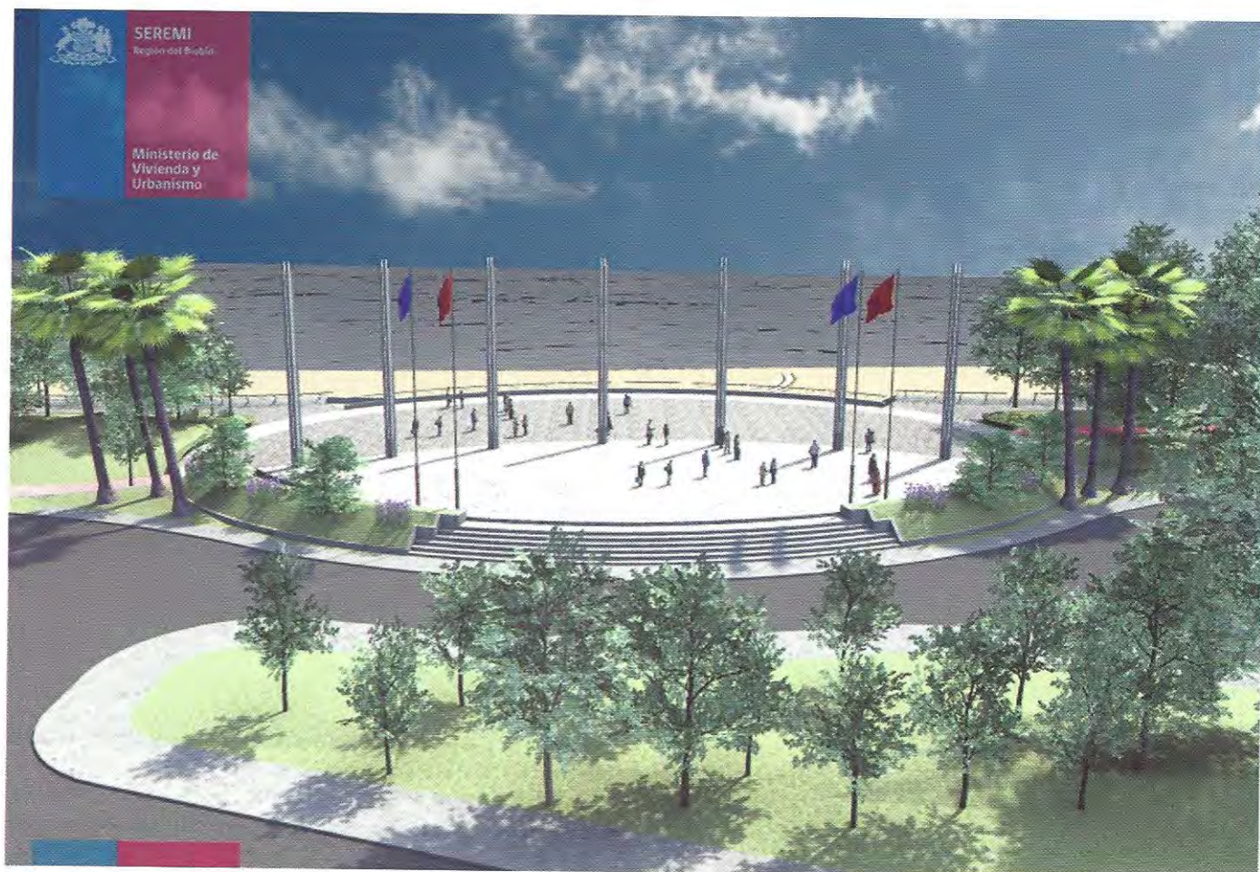
Plaza Dichato con postes de disipación de energía y barrera de vegetación arbórea MOP/DOP.
