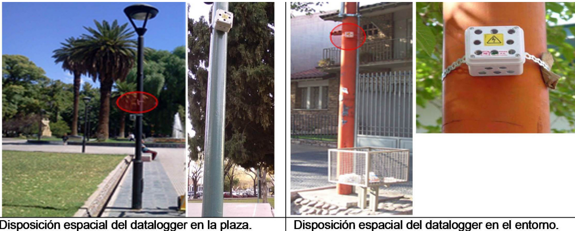
Figura 4. Disposición y colocación de los sensores de medición en la plaza y en el entorno. Fuente: Elaboración de los autores.
